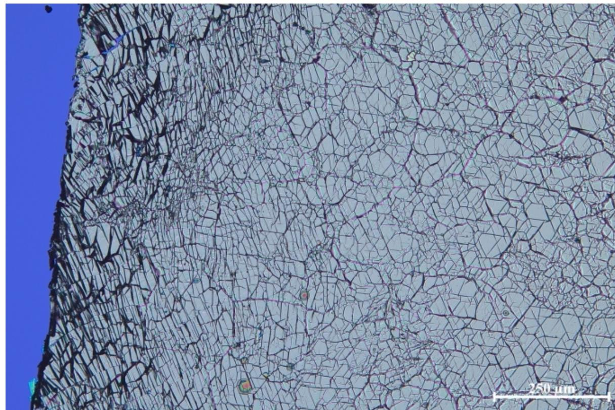
转移至SiO<sub>2</sub>/Si衬底上的石墨烯膜
